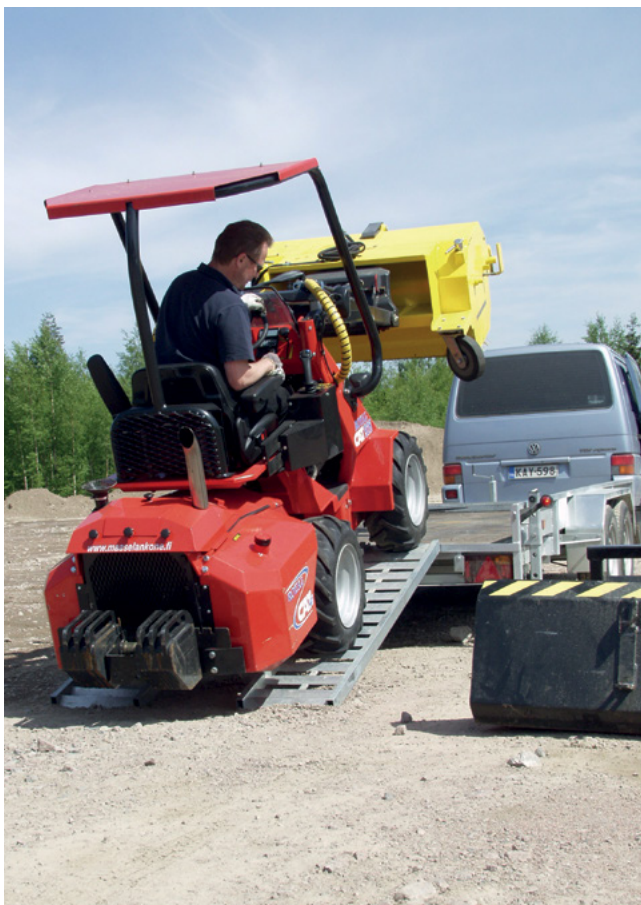
Skyddsåge och säkerhetsbälte i kompaktlastare.
