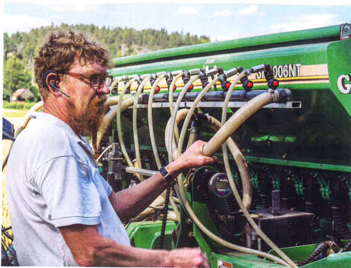
Petri Kapuinen kumppaneineen kehitti kylvö-koneeseen laitteen, jolla ammoniakkiliuos voidaan sijoittaa maahan ennen kylvöä tai kylvön yhteydessä. Sijoitukselle on omat vantaat ja säiliö kulkee etukuormaajan trukki-haarukoissa.
