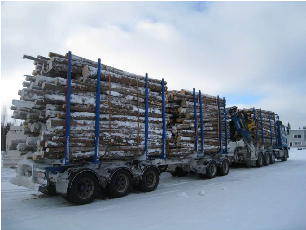
Kuva 12. Rangan autokuljetukseen käytettiin 76 tonnin puutavara-autoa, jossa puutavarakuormain on mukana kuljetuksen ajan.
