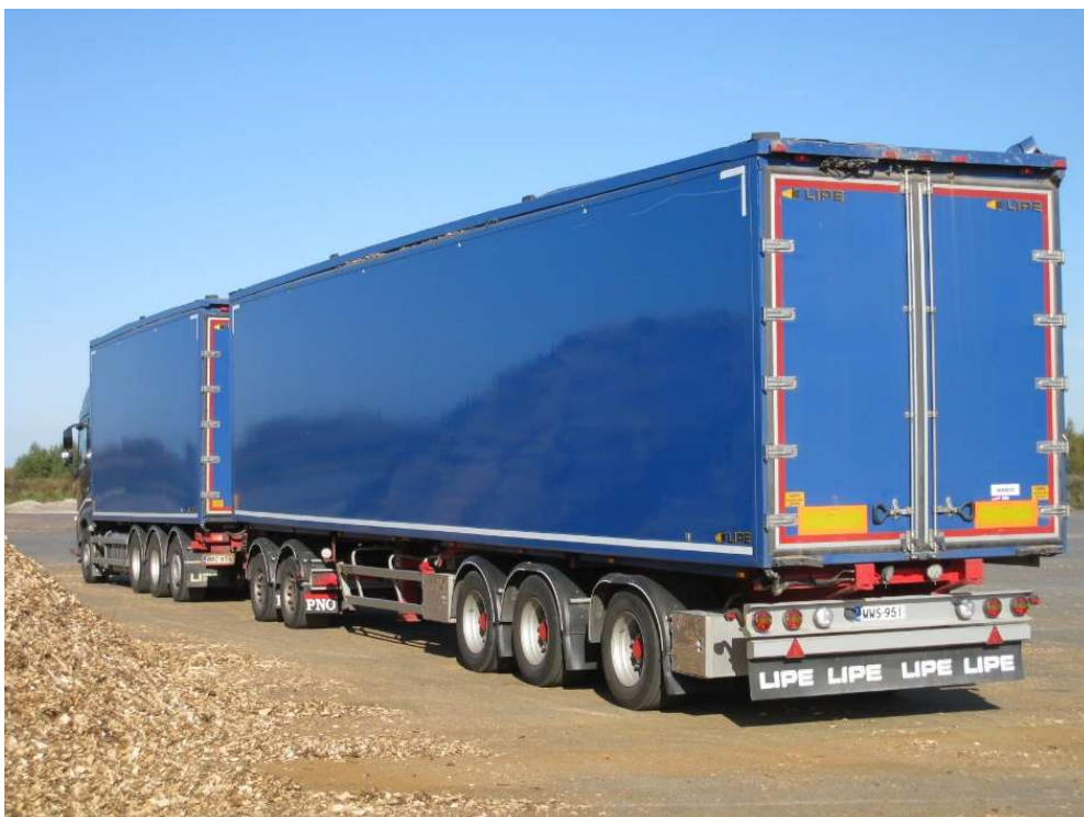
Kuva 13. Vertailuanalyyseissä hakkuutähde- ja kokopuuhaake kuljetettiin 69 tonnin kääntyväakselisella hakeautolla.
