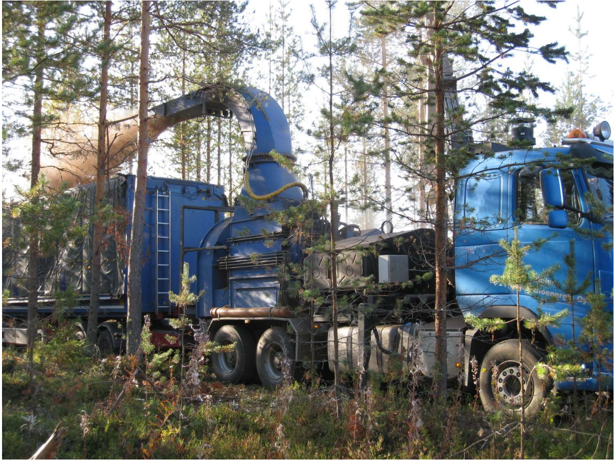
Kuva 9. Tuore puu ei pölyä hakettaessa (Kuva: Juha Laitila/Luke).
