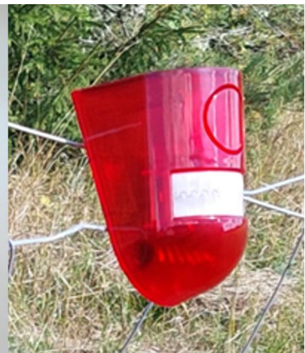
Kuva 6 Ääni- ja valokarkottimia käytettiin akuuteissa tilanteissa, esimerkiksi susihavaintojen lisääntyessä tai vahingon jälkeen. Vasemmalta oikealle: Critter gitter -äänikarkotin, Foxlights-valokarkotin ja Solaralarm-valokarkotin.
