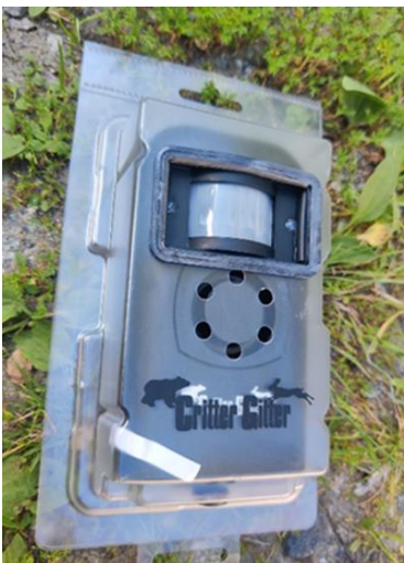
Kuva 6 Ääni- ja valokarkottimia käytettiin akuuteissa tilanteissa, esimerkiksi susihavaintojen lisääntyessä tai vahingon jälkeen. Vasemmalta oikealle: Critter gitter -äänikarkotin, Foxlights-valokarkotin ja Solaralarm-valokarkotin.
