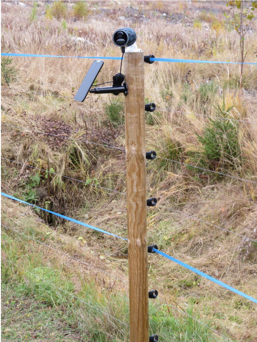
Kuva 5 Riista- ja valvontakameroista saatu palaute oli myönteistä. Etenkin valvontakamerat koettiin hyödyllisiksi laidunalueen valvonnassa. Kuvassa petoaitaan kiinnitetty, akkukäyttöinen Reolink-valvontakamera sekä lisävarusteena aurinkopaneeli.
