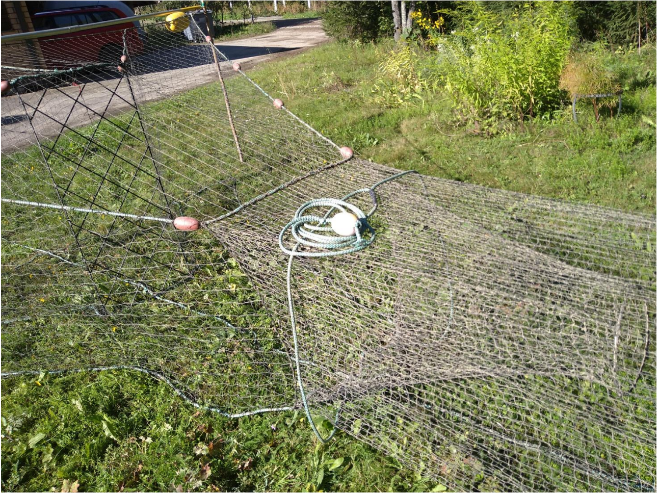
Valokuva 9. Rysän kalapesän nielu ja koentaköysi. Koentaköydestä rysä nostetaan pintaan sitä koettaessa. Koentaköysi kiinnitetään kalapesän pohjaan heti etupesän ja kalapesän liitoksen taakse. Kuvassa näkyy myös etupesän kappaleiden (potku, pohja ja katto) liitos kalapesään.
