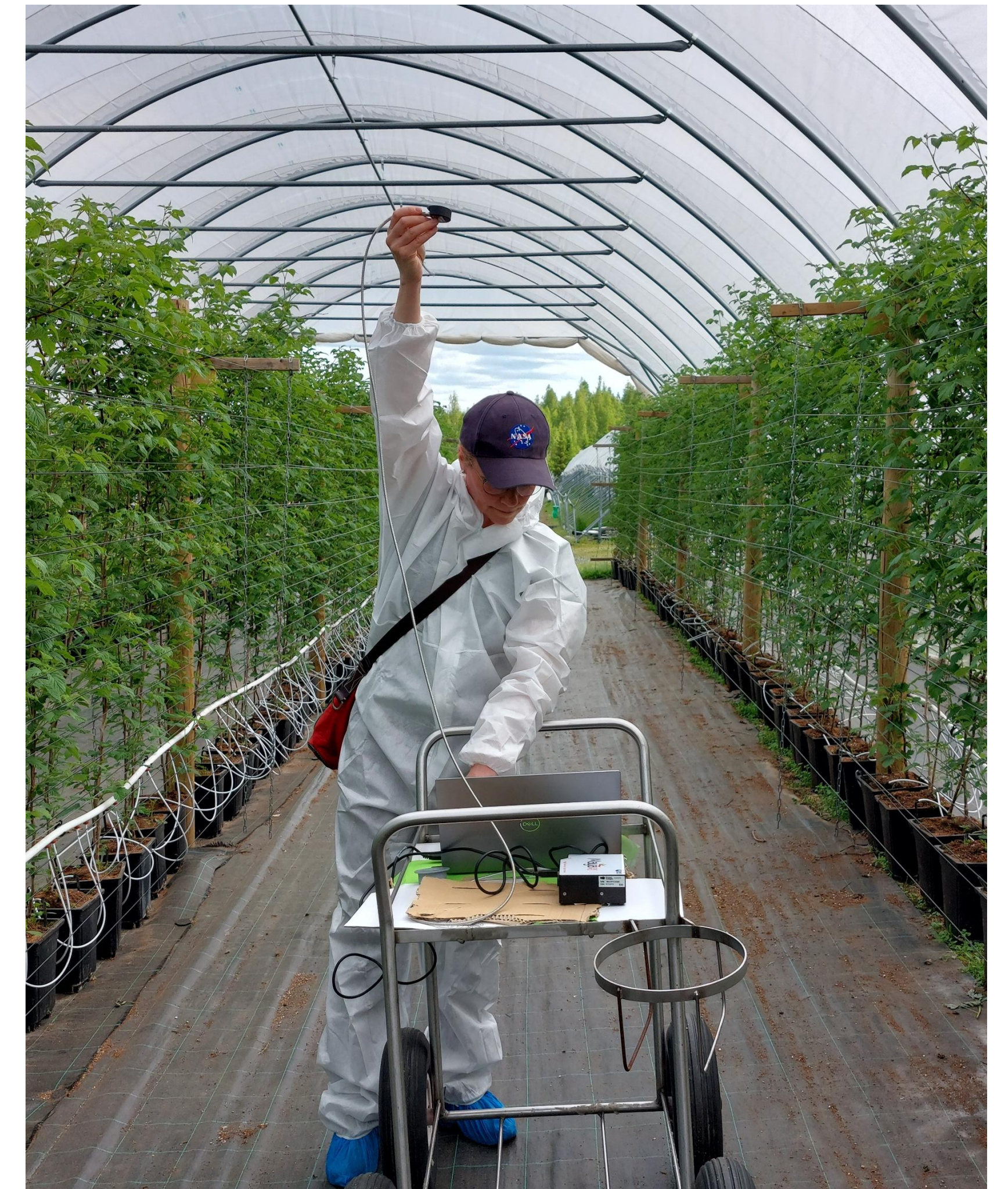
Kuva 1. Valomittauksia tehtiin spektroradiometrillä (Maya2000Pro Ocean Optics) mansikka- ja vadelmatunneleissa, tunnelin rakenteiden ja kasvien varjostus huomioiden.
