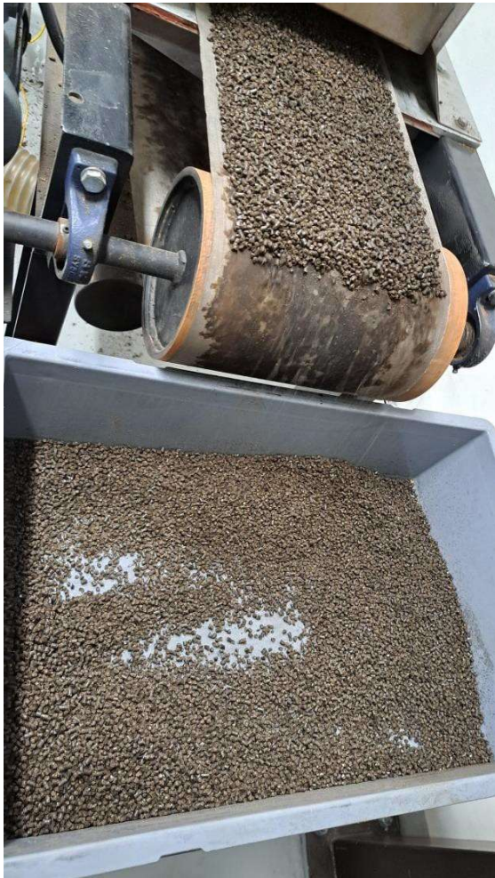
Kuva 13. Kasvatuskokeisiin tuotettu suurempi pellettierä kuivattiin imemällä huoneilmaa pellettipedin läpi viirakuivurissa.
