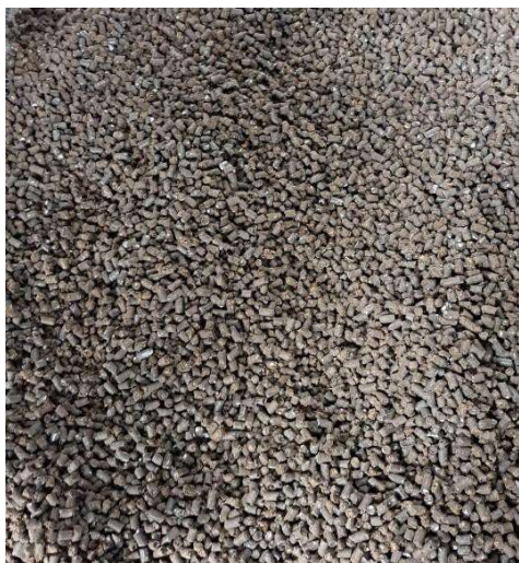
Kuva 14. 2:1 puristussuhteen pelletit eivät enää olleet kiiltäväpintaisia
