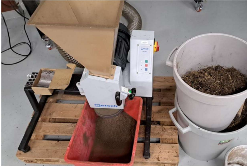
Kuva 10. Kuivatun kuivajakeen jauhaminen leikkurimyllyllä.
