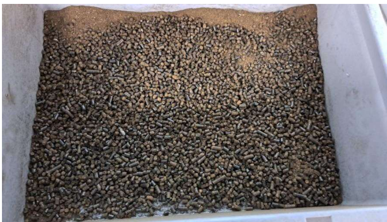
Kuva 12. Ensimmäinen pellettiajo kuivatulla ja jauhetulla kuivajakeella oli onnistunut
